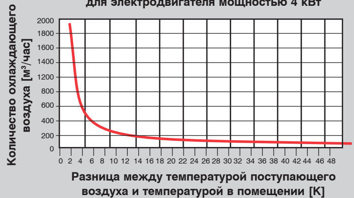
Необходимый приток воздуха для электродвигателя мощностью 4 кВт
